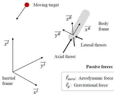
이때 2 개의 좌표계를 고려하는데, 하나는 Cartesian Inertial frame (관성좌표계) 이며 다른 하나는 비행체에 부착된 Body frame (지역좌표계) 이다. 비행체 에이전트 상태의 일부로서 비행체의 위치 (3 차원), 자세 (쿼터니언), 속도, 각속도가 있으며 목표지점의 위치 및 속도는 매 시간간격 마다 측정 (measurement) 이 가능하다고 가정한다. 에이전트의 제어신호는 2 개의 축 추력과 1 개의 길이 방향 축 추력으로 가정한다. 더욱 현실적인 제어신호로서 핀 기반 제어를 생각해 볼 수 있으나, 본 논문에서는 추력기반 제어기만을 고려한다. 본 시뮬레이션 환경은 MuJoCo [1] 물리시뮬레이터 위에서 구성되었으며, 비행체 시뮬레이션 환경 구성에 대한 내용은 본 연구의 사전 연구로서 진행된 바가 있다 [6].
