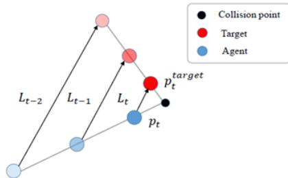
에이전트와 목표지점의 상대속도벡터가 항상 line of sight 와 정렬되어 있다면 위 그림과 같이 충돌 삼각형 (collision triangle)을 형성할 것이다. 이 충돌 삼각형은 전통적 비행체 제어기법 [5] 에서도 등장하는 개념이며, 이를 통해 본 연구에서 제안된 **data-driven** 제어기 학습 방법이 모델기반 제어기 학습 방법과 일맥상통하는 측면이 존재한다는 것을 보여준다.
